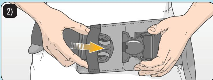
2) Führe den männlichen Teil der Schnalle durch die elastische Sicherheitsschleufe und schließe die Schnalle. Die Schnalle ist dann richtig geschlossen, wenn es laut klickt und der Verschluss auf beiden Seiten eingerastet ist.
